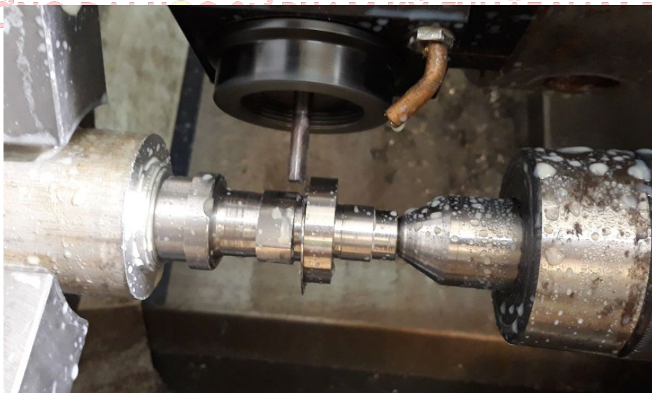
Hình 3.23: Sản phẩm sau khi thực hiện gia công phục hồi
