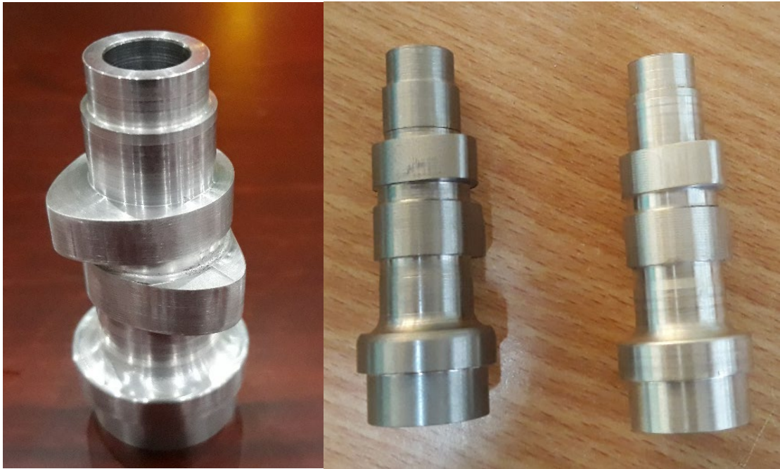
Hình 3.24: Hình ảnh chi tiết sau khi được gia công phục hồi
