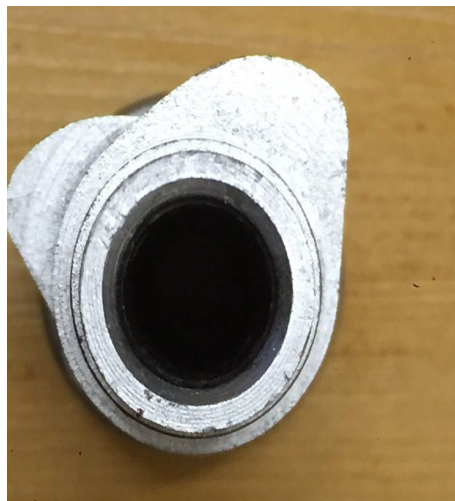
Hình 3.4: Chi tiết sau khi phun phủ
