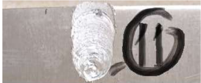
Hình 3.14. Đường hàn khi hàn bằng đầu khuấy số 2 ở lần hàn thứ 2
