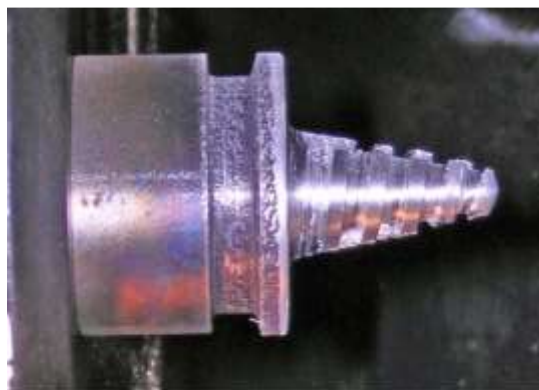
Hình 2.19.. Một dạng thiết kế cơ bản đầu ngoáy thép molybdenum sau khi hàn hợp kim nhôm 6082 với độ dày 40 mm giống như trong hình mà đầu dụng cụ không bị mòn
