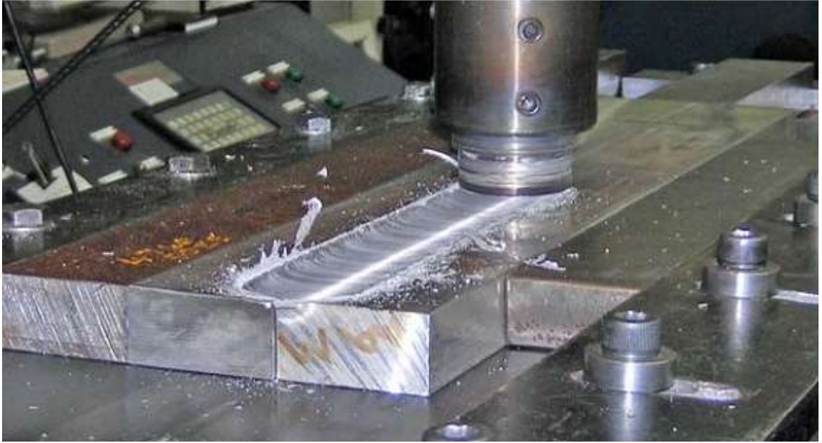
Hình 2.18. Hàn hợp kim nhôm 6082 dày 40 mm bằng đầu ngoáy thép Molybden
