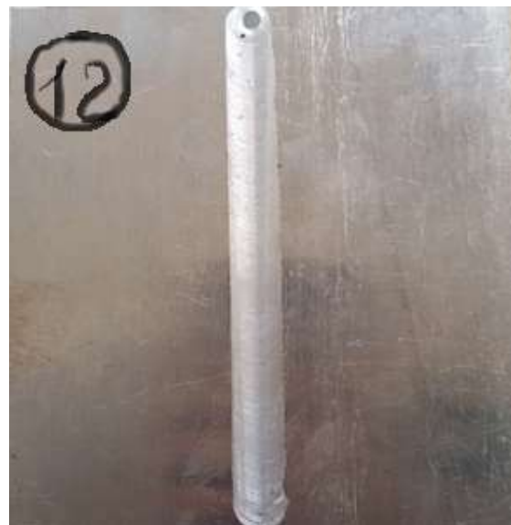
Hình 3.15. Đường hàn khi hàn bằng đầu khuấy số 3 ở lần hàn thứ 1
