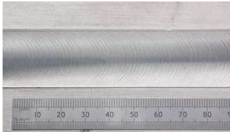
Hình 2.24. Bề mặt của mối hàn hợp kim nhôm 6083-T6 hàn với hai đầu khuấy Tandem Twin-Stir™
