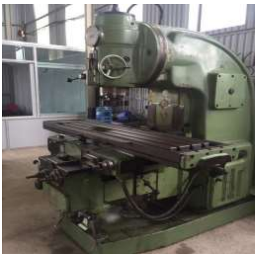
Hình 3.9. Máy phay dùng để hàn thực nghiệm
