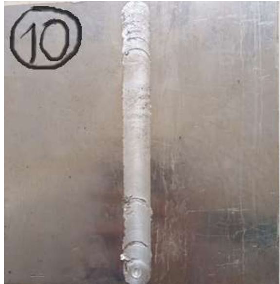
Hình 3.13. Đường hàn khi hàn bằng đầu khuấy số 2 ở lần hàn thứ 1
