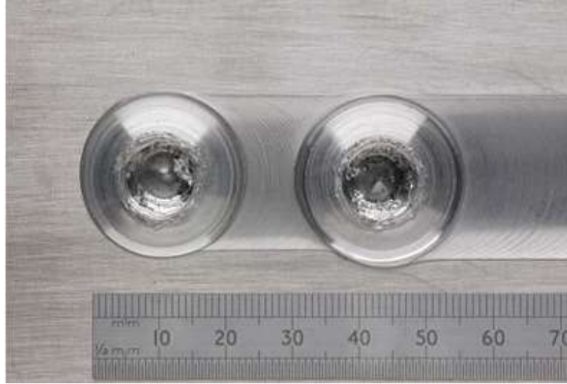
Hình.2.26. Lỗ khuyết lõm khi kết thúc quá trình hàn bằng phương pháp hàn hai đầu ngoáy (Tandem Twin-stir™)
