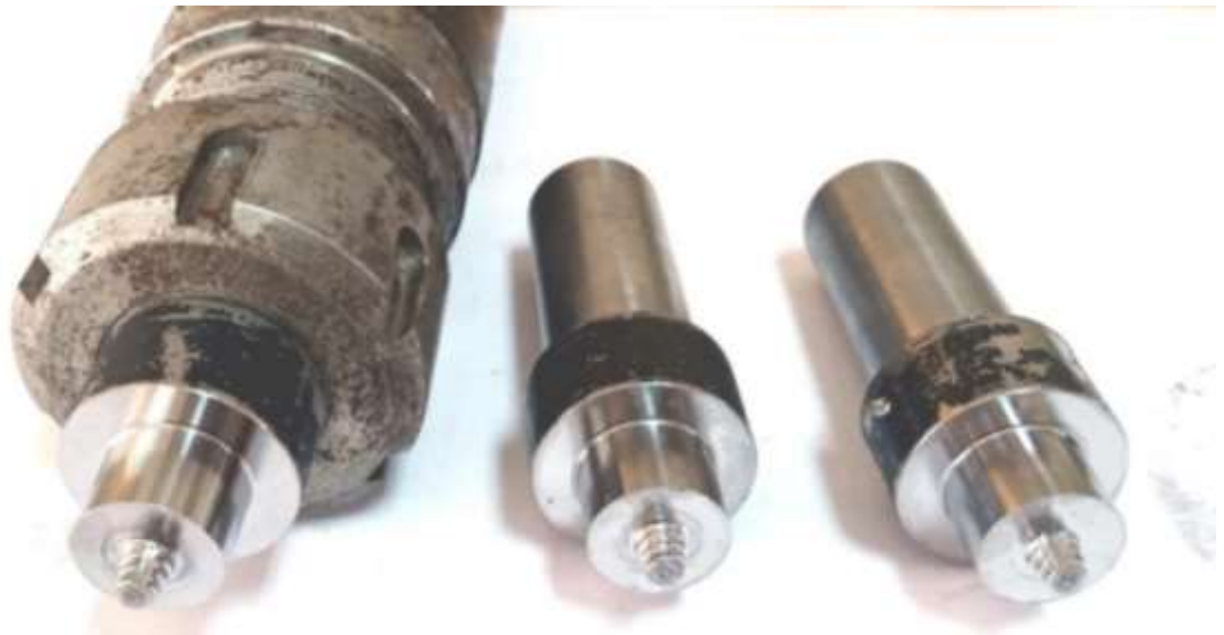
Hình 3.6. Hình ảnh đầu khuấy dùng trong thực nghiệm
