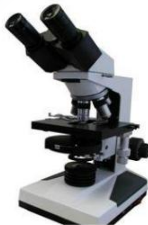
Hình 2.10. Đo độ nhám bằng kính hiển vi quang học
