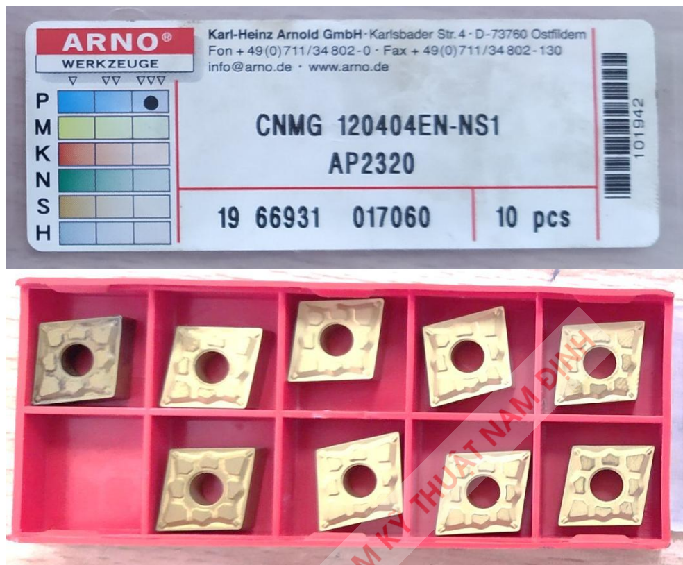
Hình 3.6. Phần cắt của dao dùng để gia công mẫu thí nghiệm
