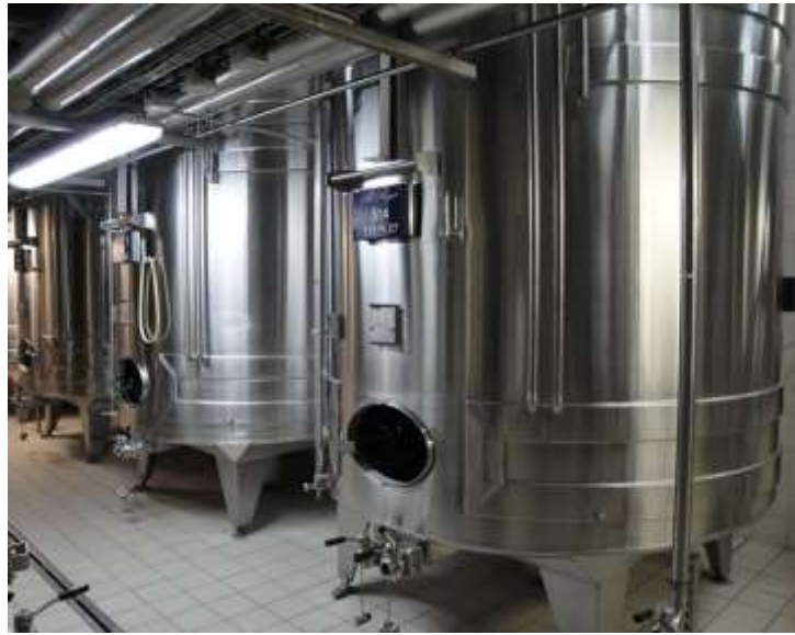
Hình 1.7. Bồn chứa hóa chất, xăng dầu... được làm từ thép sus 316
