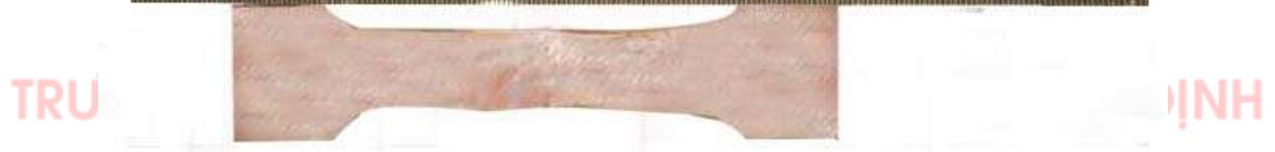
Hình 3.17. Mẫu thử kéo theo AWS D1.6[17].
