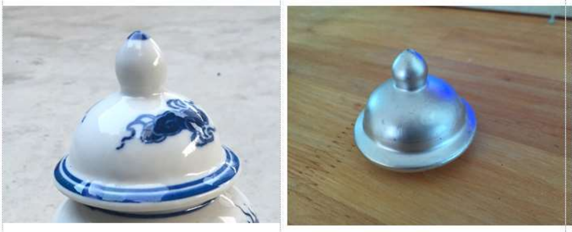
Hình 3. 13: Chi tiết nắp đậy chóc thờ trước và sau khi phun phủ
